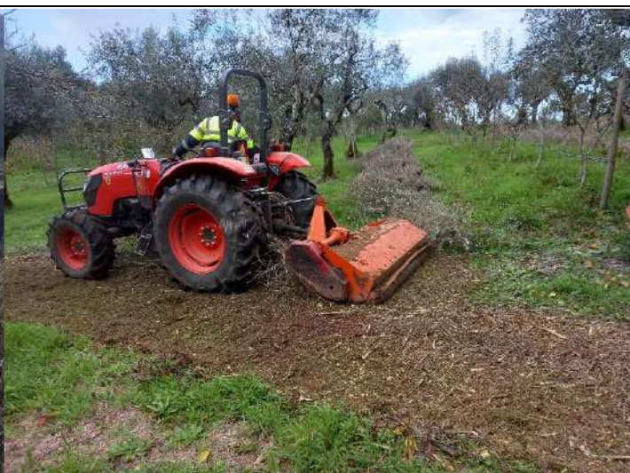
Figura 1.3 – Trituração da rama da oliveira (em vez da prática ainda dominante da queima), com destrojador de martelos, transformando um subproduto num corretivo orgânico para o solo e promovendo o sequestro de carbono que ajuda a compensar as emissões de gases com efeito de estufa (GEE) como o CO 2 (Ferreira do Zêzere, 20/11/2021)
