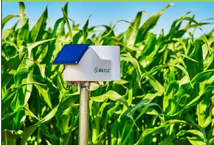
Figura 16.1 – Estação meteorológica alimentada a energia solar e com transmissão dos dados pela internet
