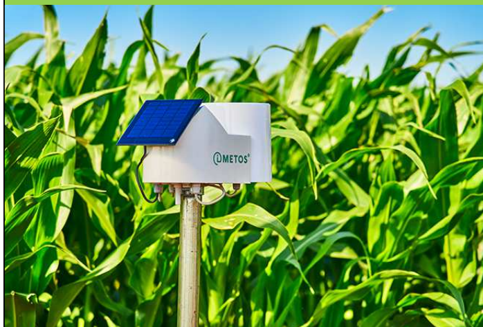
Figura 1 – Estação meteorológica alimentada a energia solar e com transmissão dos dados pela internet
