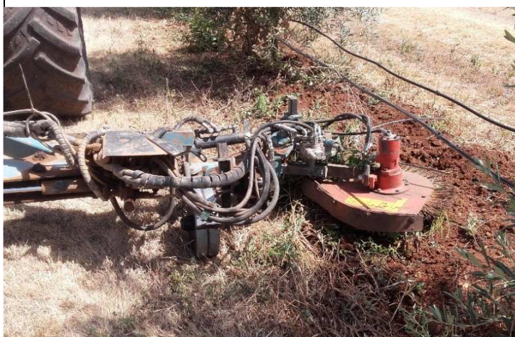
Figura 3 – Alfaia interfilar para eliminar a erva na linha com mobilização superficial do solo em olival intensivo sem herbicida e em agricultura biológica (Serpa, 2020)
