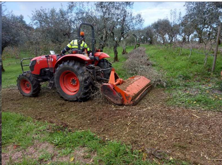
Figura 3 – Trituração da rama da oliveira (em vez da prática ainda dominante da queima), com destroçador de martelos, transformando um subproduto num corretivo orgânico para o solo e promovendo o sequestro de carbono que ajuda a compensar as emissões de gases com efeito de estufa (GEE) como o \text{CO}_2 (Ferreira do Zêzere, 20/11/2021)
