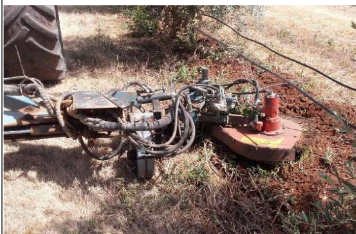
Figura 8.3 – Alfaia interfilar para eliminar a erva na linha com mobilização superficial do solo em olival intensivo sem herbicida e em agricultura biológica (Serpa, 2020)
