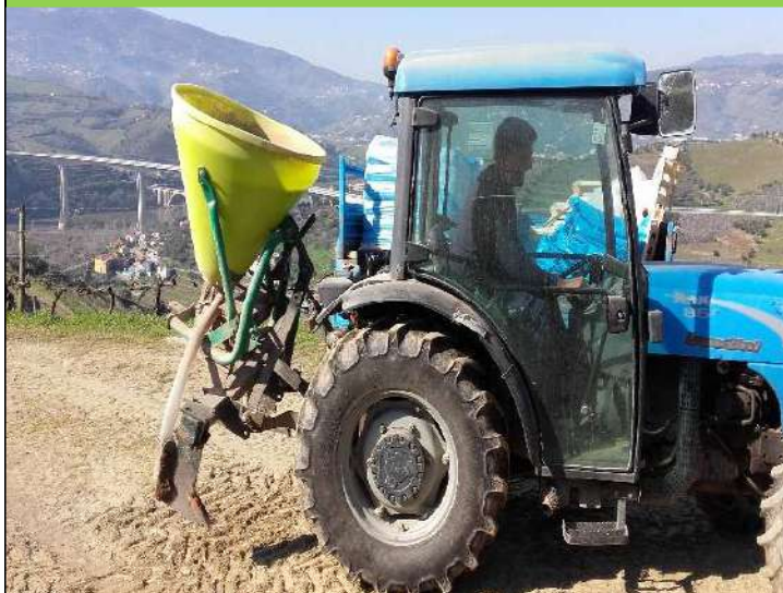
Figura 7.1 – Adubador localizador para aplicação de adubos orgânicos ou minerais, granulados ou peletizados (Peso da Régua)
